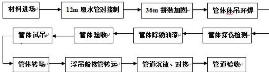
图 3.4-3 引水管制作工艺
